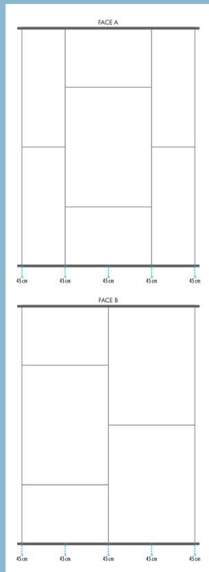
Schéma des deux faces réalisées en plaques Knauf TOP posées en alternance. Une base débutant par une plaque entière se verra adjoindre de façon symétrique une demi-plaque sur la paroi d'en face.
